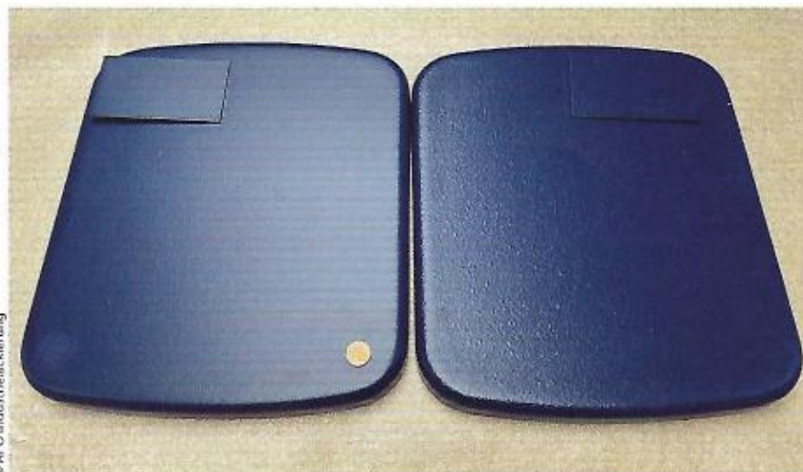
Durch die Variation von Equipment, Lackkonsistenz und Prozessparameter lassen sich maßgeschneiderte Strukturen erzeugen.
