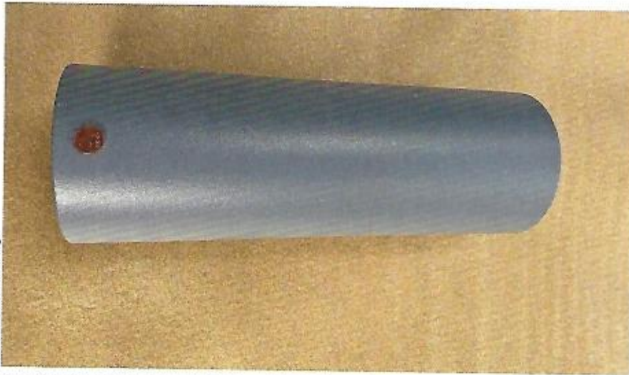
Gewölbte Bauteile wurden im Projekt nach Herstellerangaben mit Struktur lackiert (die 1-Cent-Münze dient auch in folgenden Bildern als Maßstab).
