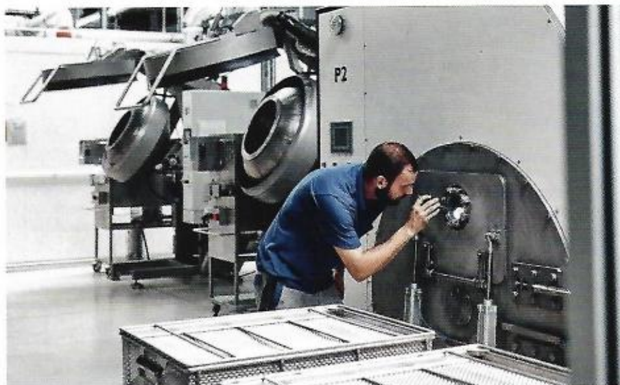
Im zweiten Schritt des optimierten Vorbehandlungsprozesses für Silikone werden die O-Ringe im Hochfrequenz-Niederdruckplasma aktiviert, hier prüft ein Mitarbeiter visuell den Prozess.
