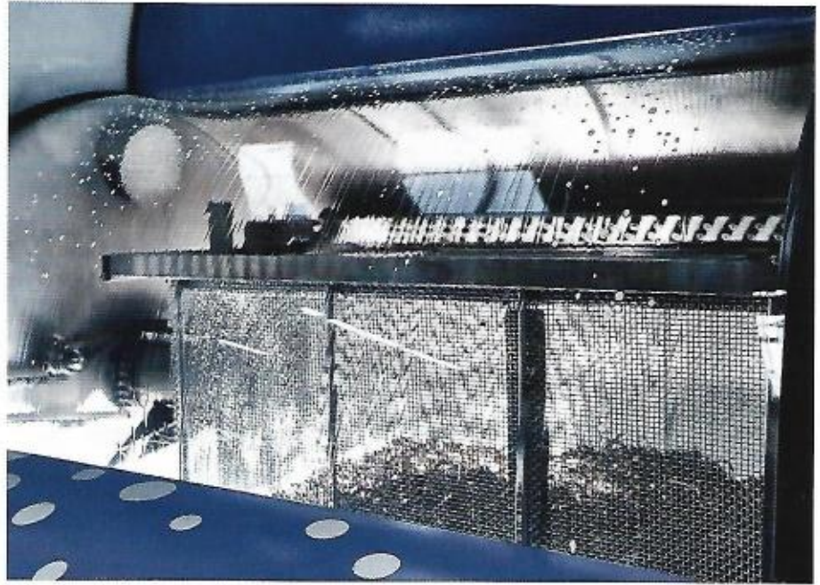
O-Ringe durchlaufen im ersten Schritt des optimierten Vorbehandlungsprozesses eine Nassreinigung mit Temperaturkontrolle und speziellen Reinigern.
